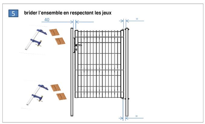
Poser le portillon et Caler le portillon remplir les réservations de béton à 250 Kg mini 6 Vérifier la verticalité Lisser le béton
