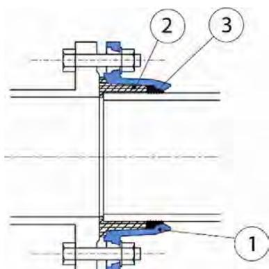
**1-Contre-bride** : fonte GS revêtu de poudre époxy bleu 250 microns d'épaisseur moyenne avec un mini de 200 microns, conforme à la norme EN 14901 (PECB)
