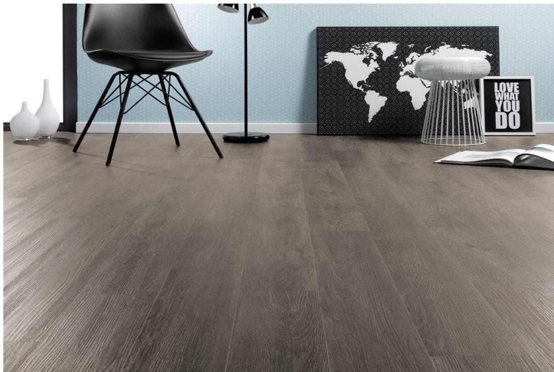
Entreposez les lames vinyles dans la pièce où elles seront installées, à température ambiante (entre 19 et 25 °C) et cela pendant 48 heures, avant de commencer la pose. Les lames doivent rester dans leur emballage, sur une surface absolument plane.
