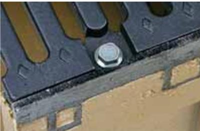
Chaque grille de 50 cm de longueur est reliée aux feuillures par 4 vis traitées contre la corrosion. Les trous filetés des feuillures sont autonettoyants, ils débouchent sur un évidement. La conception de la cavité recevant la tête de vis évite toute accumulation de boue gênant le démontage.
