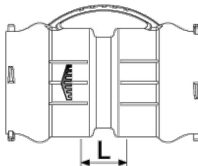
**Manchon KLIKSO en fonte ductile pour tubes PVC-U/PE pression**
