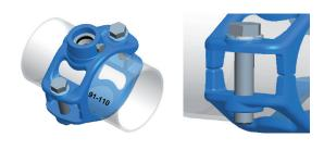
Par conception, le collier ROC GT2 est ajusté aux diamètres extérieurs des canalisations plastique, son serrage étant sécurisé en butée sur les taquets.
