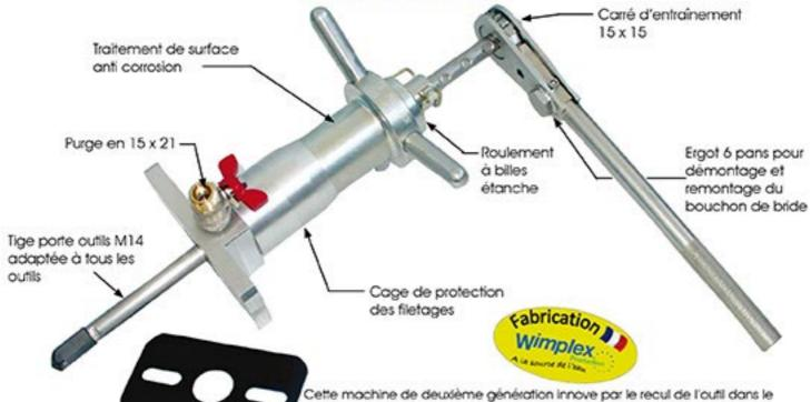
corps de la machine (nouvelle conception indispensable pour percer la canalisation Fonte BLUTOP), une seule tige porte outils pour percer latéralement ou sur le dessus, une purge copeaux intégrée,
