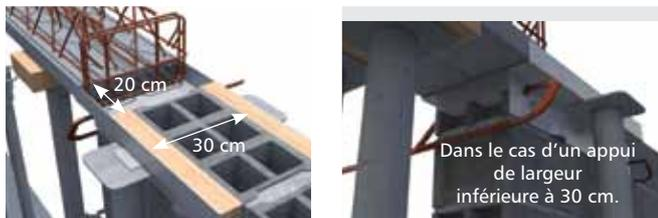
Pour des poutrelles posées jumelées et pour les cas de trémiés, il faut disposer une boucle HA 6 aux abouts.
