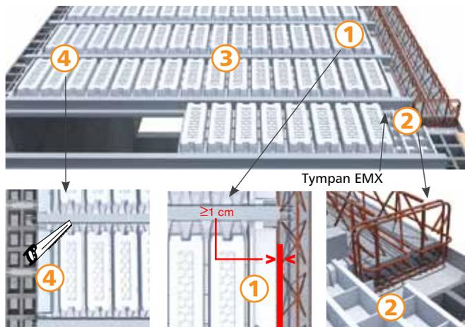
Respecter une distance de 1 cm entre l'extrémité du tympan et le treillis de la PM5.
