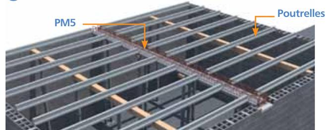
Disposer une lisse d'appui sous les poutrelles dans les cas de pose de poutrelles sans étais et de mise en œuvre de poutrelles  $\geq 3$  m.
