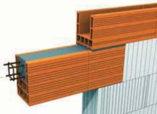
**Brique linteau d'ouverture utilisée en linteau :**
