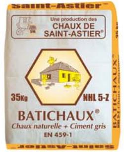
Le **BATICHAUX®** est une chaux hydraulique naturelle composée d'une forte proportion de CHAUX NATURELLE de SAINT-ASTIER (souplesse, collage, respiration, absence de fantômes) et d'une faible quantité de **CIMENT GRIS 52,5 R** pour la résistance et la prise plus rapide du mortier.
