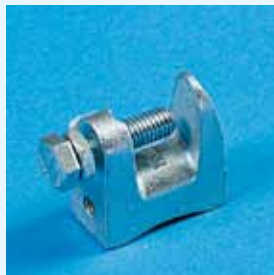
Fig. 1 ATK M6 - Charge admissible : 160 daN
