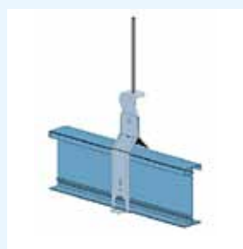
Fig. 2 Suspente I-TEC + Pivot I-TEC Charge admissible : 160 daN
