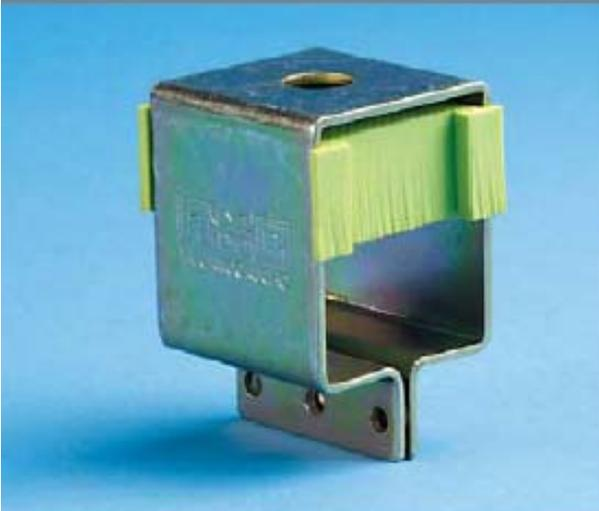
Suspension de profilé longue portée I-TEC. Tige filetée de 6 mm. Ecrou libre intégré. Vissage du profilé par 2 vis TRPF 16 mm.
