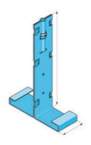
Accessoire de suspension de plafonds en plaques de plâtre en montants Placostil®
