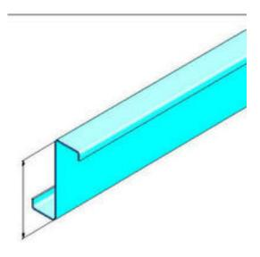
Profilé métallique utilisé pour constituer l'ossature primaire dans le cas de structures porteuses Megastil®
