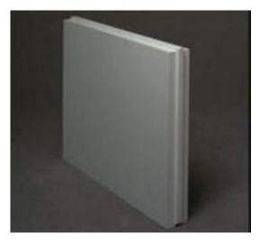
Carreau de plâtre hydrofugé, à parements lisses et bleus, dont la reprise en eau après 2 heures d'immersion est inférieure à 5%; il permet d'assurer, sans mise en ?uvre particulière la pérennité des cloisons de tout local privatif ou assimilé exposé à l'humidité.
