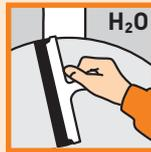
Les plaques peuvent être surfacées à l'aide d'enduit à base de ciment FERMACELL Powerpanel (enduit de surfacage et enduit de lissage FERMACELL Powerpanel), notamment en cas de revêtement peinture.
