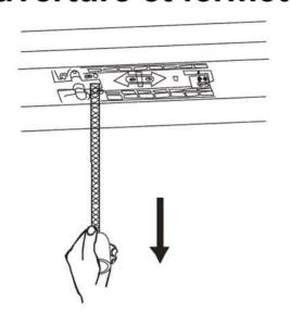
En cas de coupure de courant vous pouvez déverouiller le système en tirant simplement sur la corde pour permettre au chariot de circuler librement dans le rail
