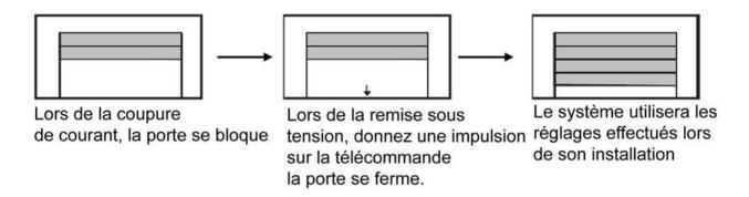
En cas de coupure de courant, l'ouverture ou la fermeture de la porte peuvent s'effectuer manuellement
