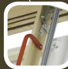
La charnière de la trappe guide son mouvement pour que pendant l'ouverture l'échelle s'éloigne automatiquement de la trappe afin d'assurer l'utilisation confortable de l'escalier.
