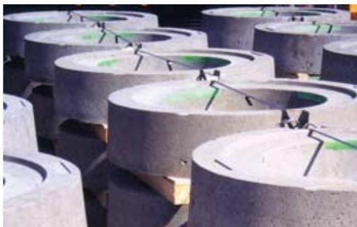
Les couronnes de répartition en béton armé doivent être stockées sur une aire plane et empilées sur 4 hauteurs maximum.
