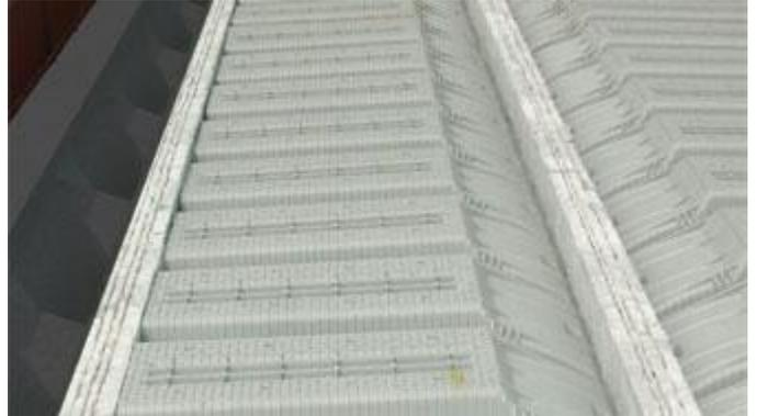
Pour les travées démodulées, l'entrevous est découpé dans le sens de la longueur, la partie coupée est mise au contact de la poutrelle. Une disposition est adoptée afin d'assurer le maintien de l'élément en place (exemple : fixation par pointage sur la maçonnerie).
