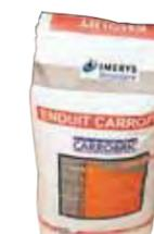
L'enduit CARROFEU est un enduit de couleur grise à base de ciment, de charges et isolants minéraux, ainsi que d'adjuvants organiques naturels. Il est déposé symétriquement sur les deux faces de la cloison Carrobric avec une épaisseur minimale de 5 à 7 mm selon les besoins Sécurité Incendie.
